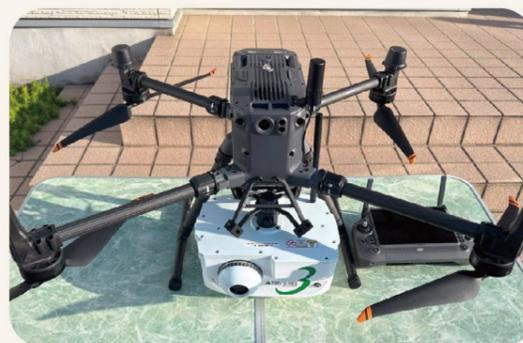
TDOT3は、水に吸収されにくいグリーンレーザを照射することで、地上から水面下までの3次元地形をシームレスに可視化できます。実際の動作と性能の確認をかねたテスト計測を行いました。県内でもUAVグリーンレーザ導入企業はわずかで、今後、河川山林等様々な業務での活躍を目指しています。
